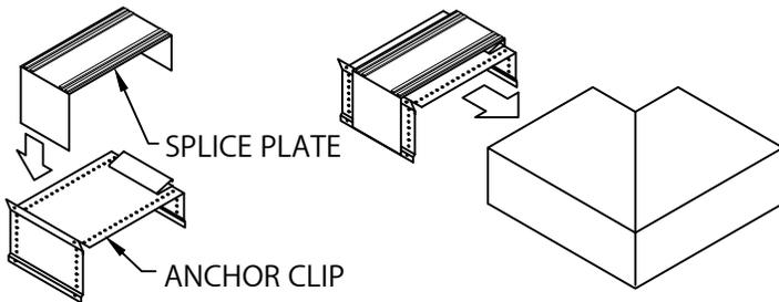
**STEP 2 - MITER SPLICE PLATES & ANCHOR CLIPS**
