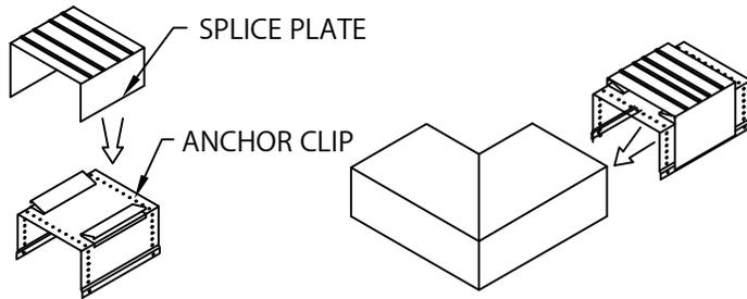
**STEP 2 - MITER SPLICE PLATES & ANCHOR CLIPS**
