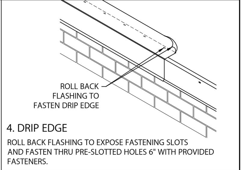
ROLL BACK FLASHING TO FASTEN DRIP EDGE
