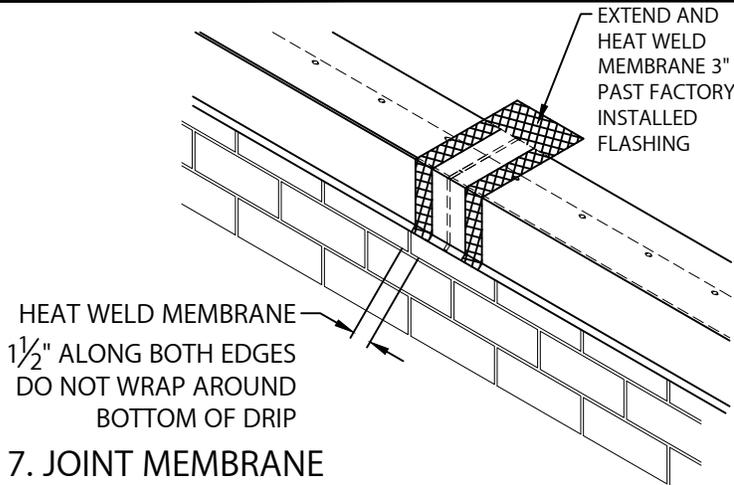
HEAT WELD MEMBRANE 1 1/2" ALONG BOTH EDGES DO NOT WRAP AROUND BOTTOM OF DRIP
