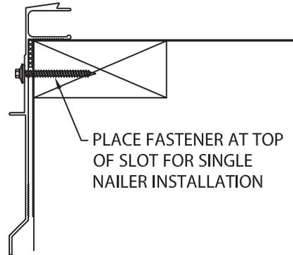
PLACE FASTENER AT TOP OF SLOT FOR SINGLE NAILER INSTALLATION
