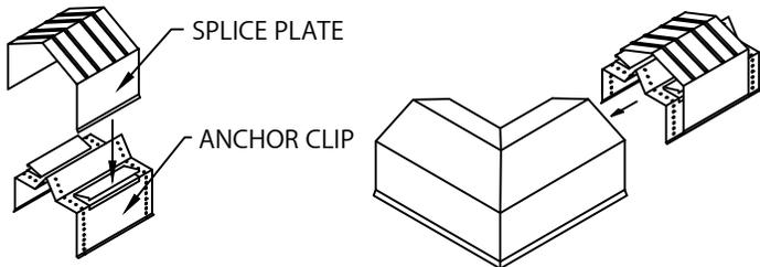
**STEP 2 - MITER SPLICE PLATES & ANCHOR CLIPS**
